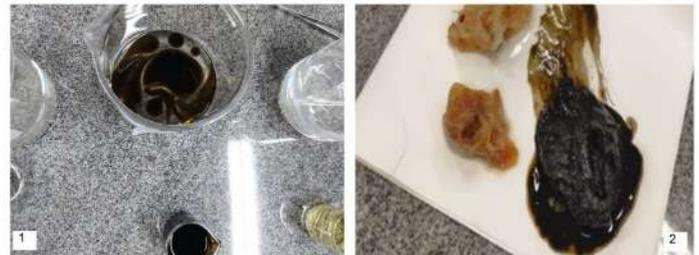
Figura 1: Óleo de motor usado juntamente com água e Figura 2: Óleos adsorvidos pela fibra de *Calotropis Procera* (Foto tirada por Iasmin Trajano)
