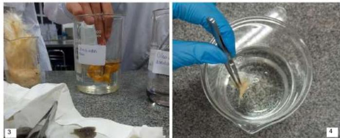
Figura 3: Óleo de motor novo juntamente com água e a fibra de *Calotropis Procera* e Figura 4: Teste da fibra em Becker com óleo de soja. (Foto tirada por Iasmin Trajano)
