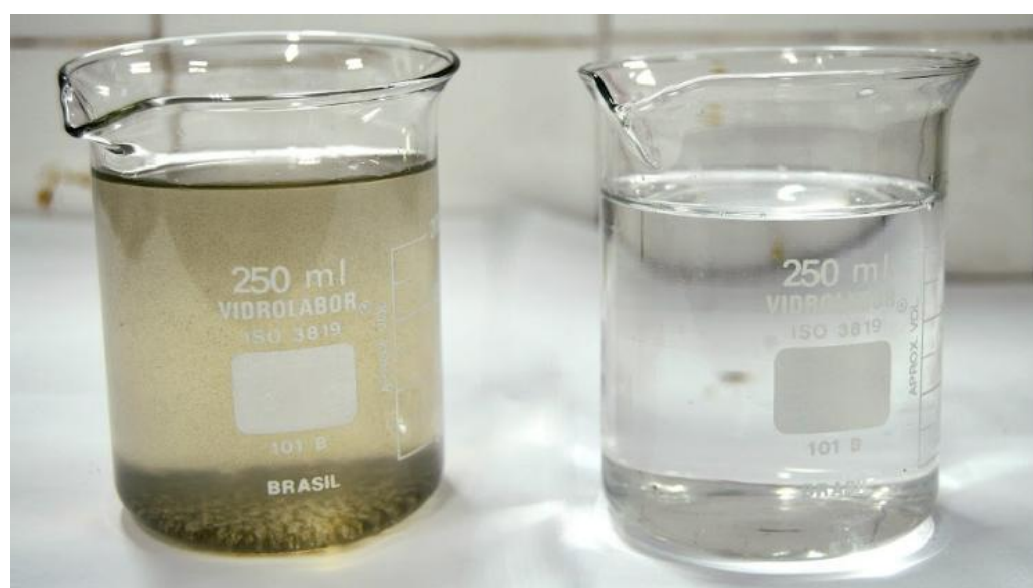
Figura 3 - Clarificação do esgoto no sistema completo Autor: Berto (2024)
