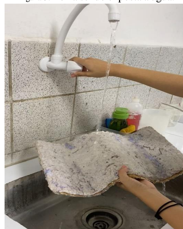
Figura 3: Telha sendo exposta a água.
