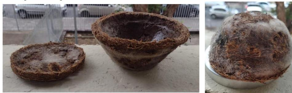
Figura 3- Protótipos mofoados produzidos sem fungicida. (FONTE: Registro dos autores do projeto.)
