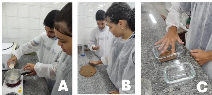
Figura 2 – A) Processo de preparo da goma de ágar-ágar; B) Processo de mistura manual da goma com o pó de coco; C) Distribuição da mistura nos moldes. (FONTE: Registro dos autores do projeto.)
