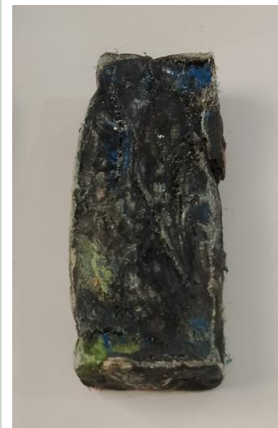
Figura 7- Bloco ecológico utilizando 59g de PP e 5 mL de óleo de cozinha usado.
