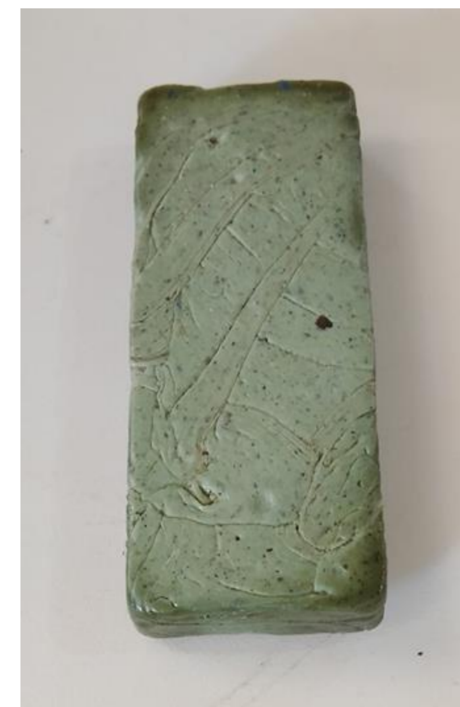
Figura 8- Bloco ecológico utilizando 100g de PET e 30 mL de óleo de cozinha usado.
