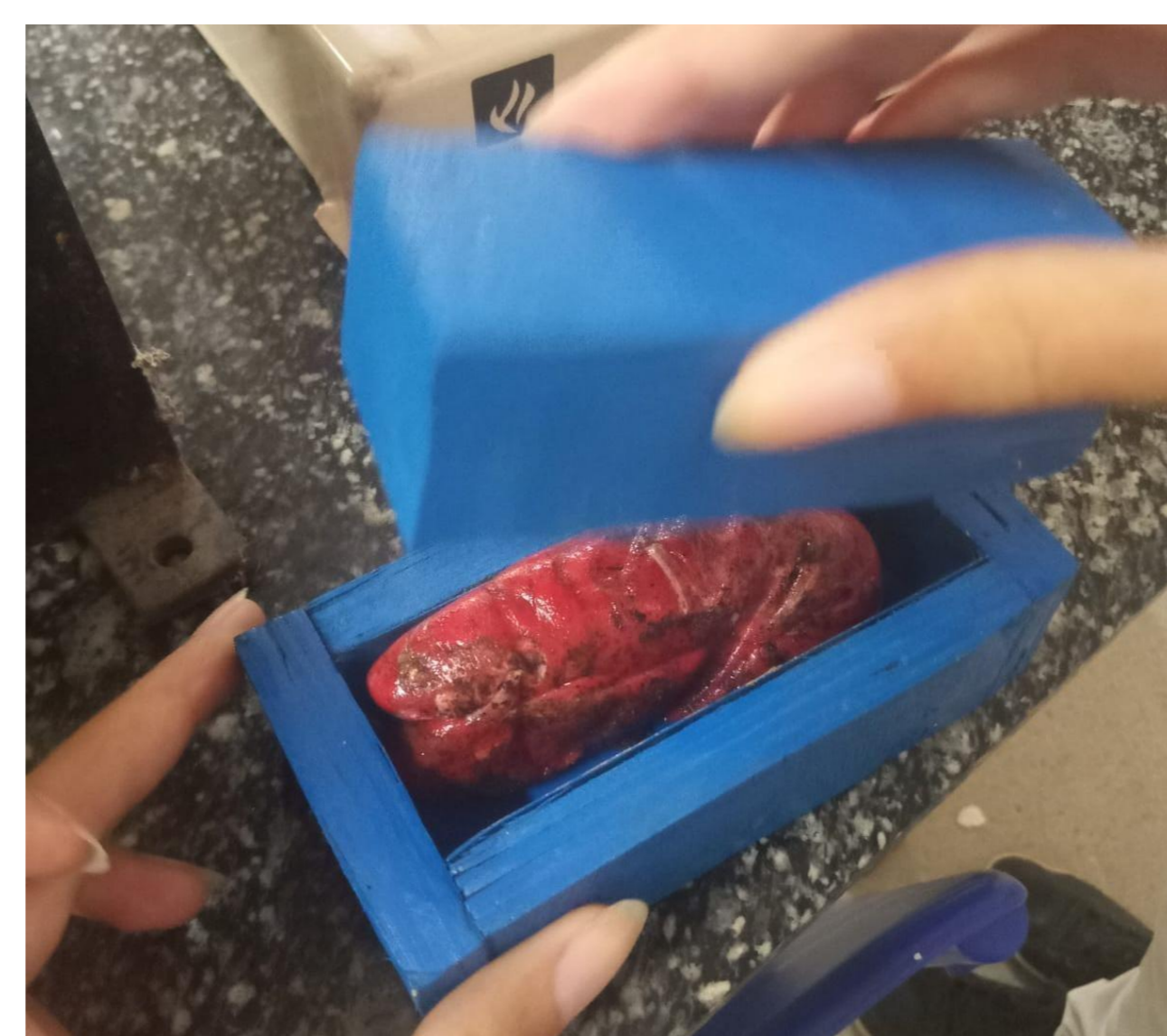
Fig. 6: Material pastoso obtido após o aquecimento sendo colocado no molde
