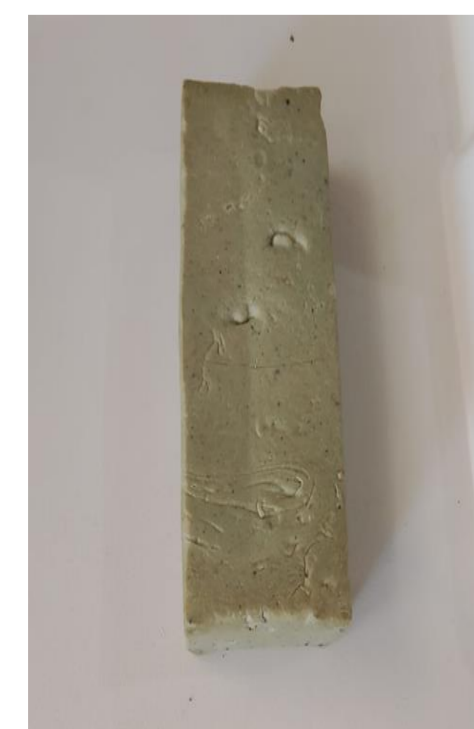
Figura 9- Bloco ecológico utilizando 100g de PET e 15 mL de óleo de cozinha usado e 30g de gesso.
