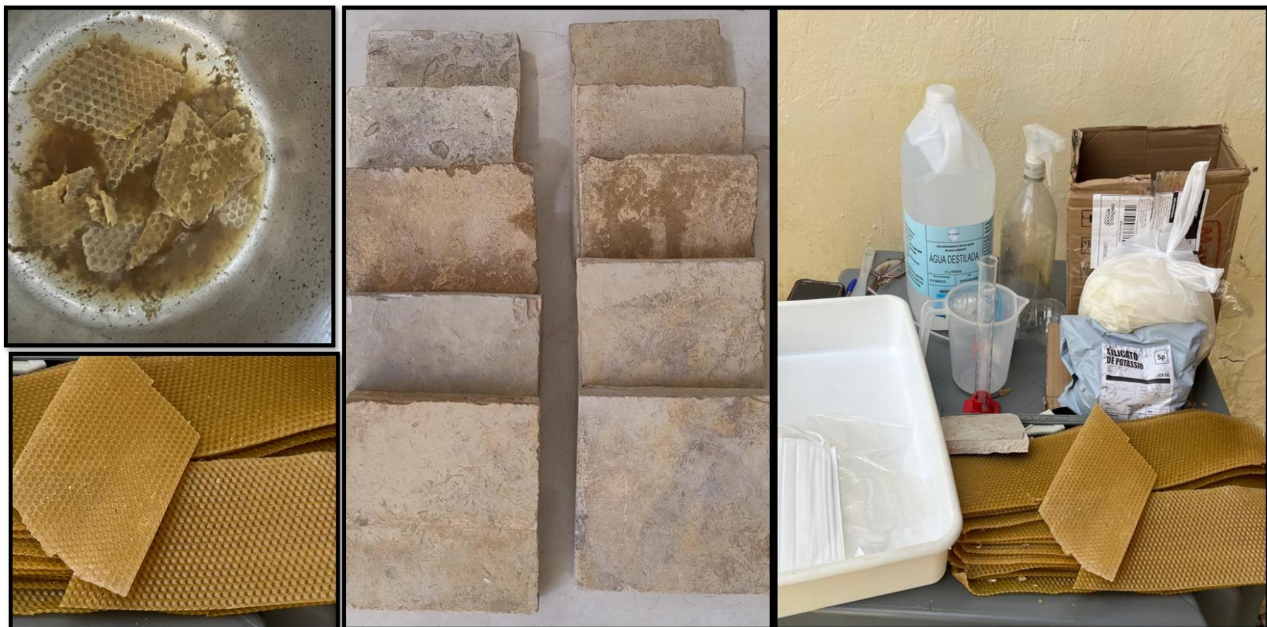
Figura 3: Material utilizado na impregnação do silicato de potássio e cera de abelha. Fonte: Acervo da pesquisa (2025)
