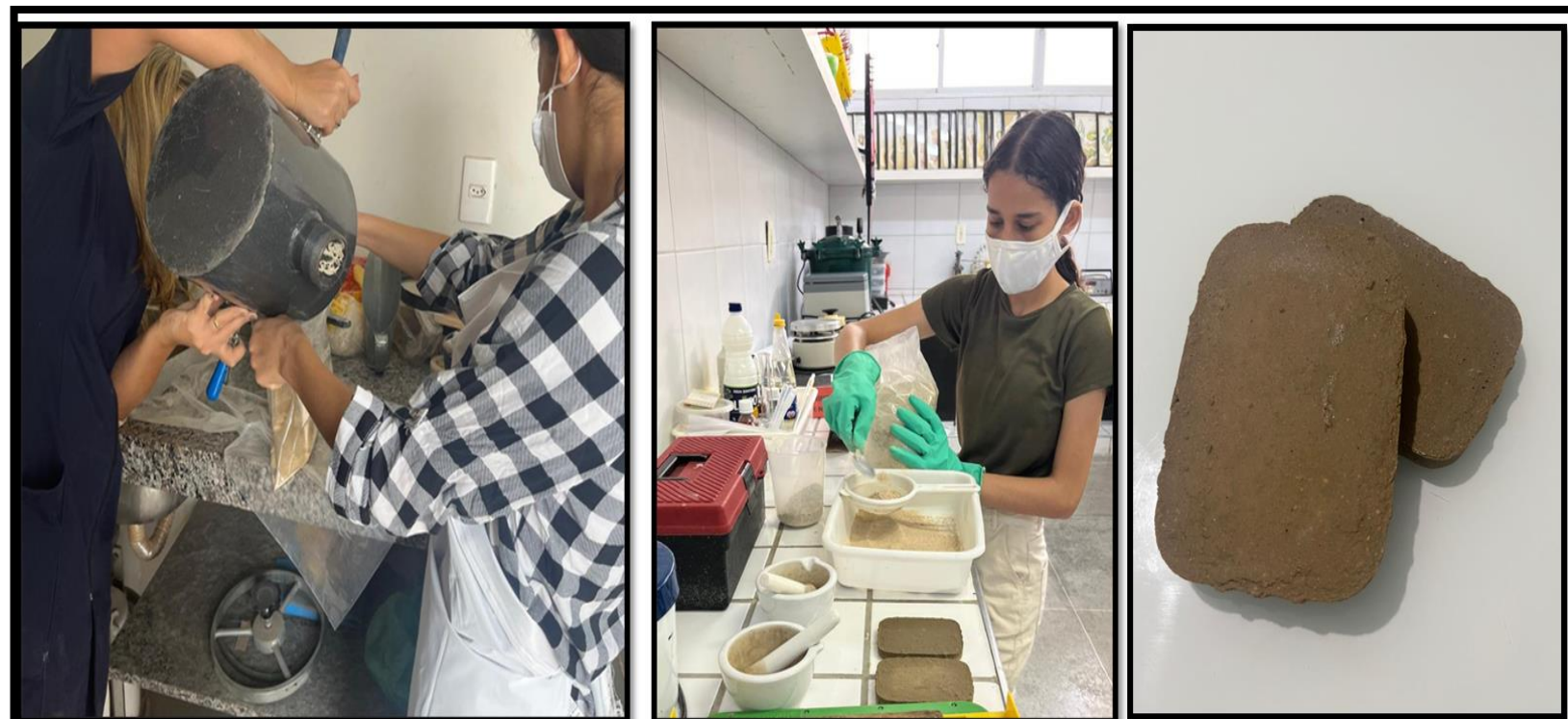
Figura 11 – Processo de formulação do piso a partir do rejeito da Pedra Cariri. Fonte: Acervo do projeto (2025).
