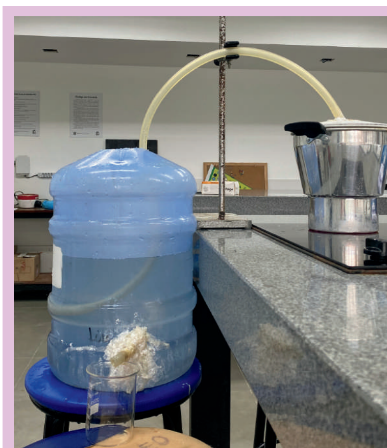
Figura 4 - Imagem do extrator de óleo essencial alternativo. (Autoras, 2025)
