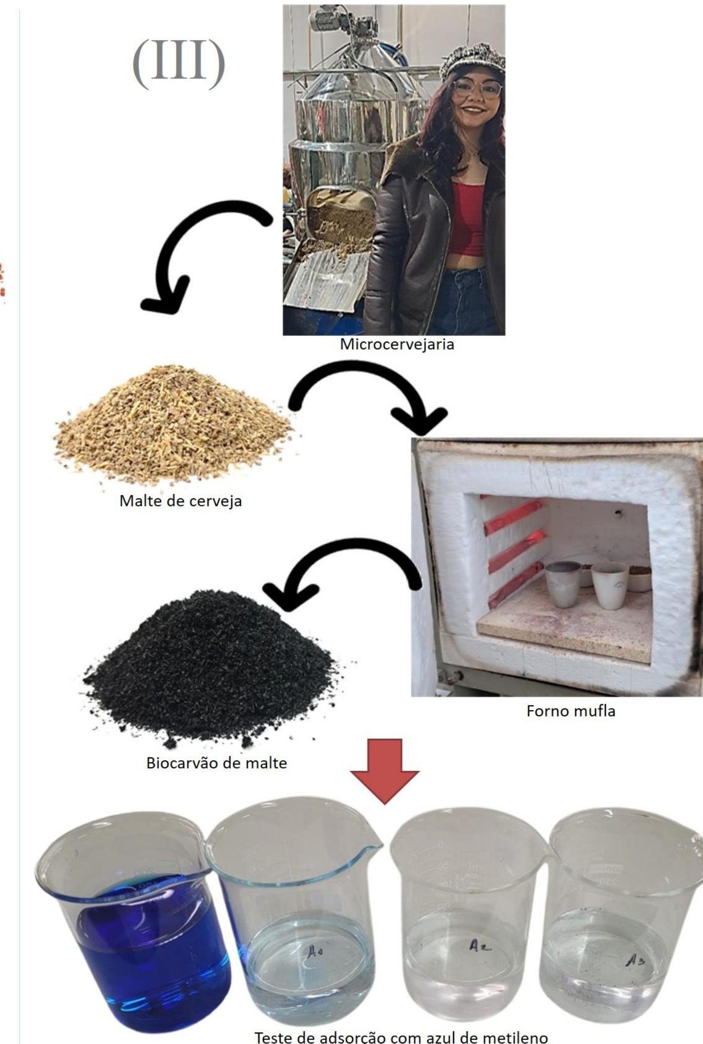
Fig. 3 - Biocarvão produzido a partir do resíduo de malte de microcervejaria para adsorção de compostos orgânicos. Fonte: Autores, 2025. Referência bibliográfica: [3].
