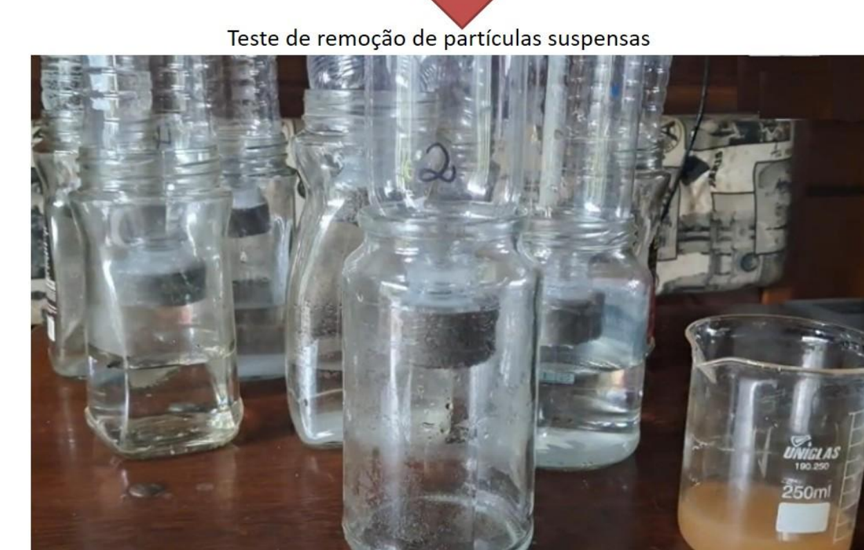
Fig. 1 - Filtro de cimento CP V-ARI e agregado basáltico para retenção de macropartículas. Referência bibliográfica: [1].
