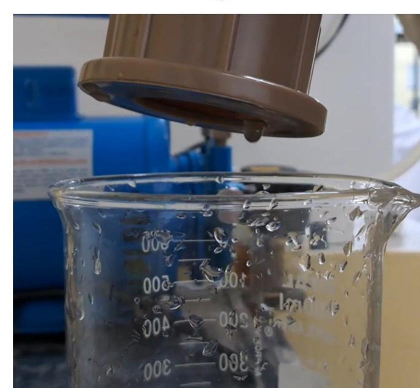
Fig. 2 - Filtro de argila com casca de ovo moída, voltado à remoção de micropartículas. Fonte: Autores, 2025. Referência bibliográfica: [2].
