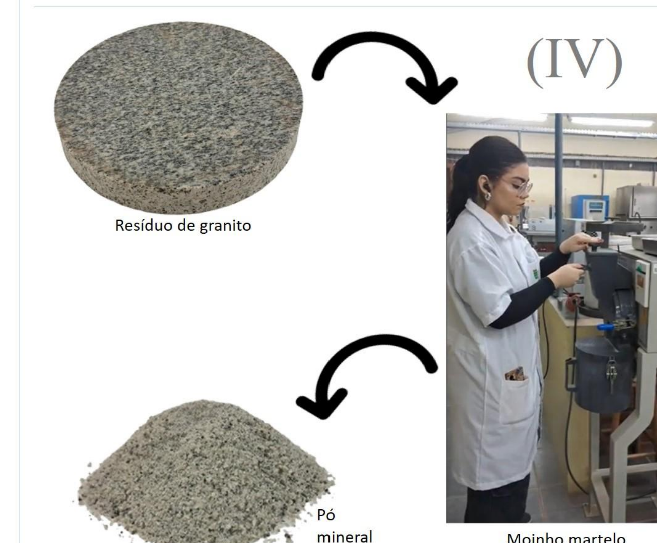
Fig. 4 - Pó mineral de resíduo de granito para remoção de metais pesados, ainda em fase experimental. Fonte: Autores, 2025. Referência bibliográfica: [4].
