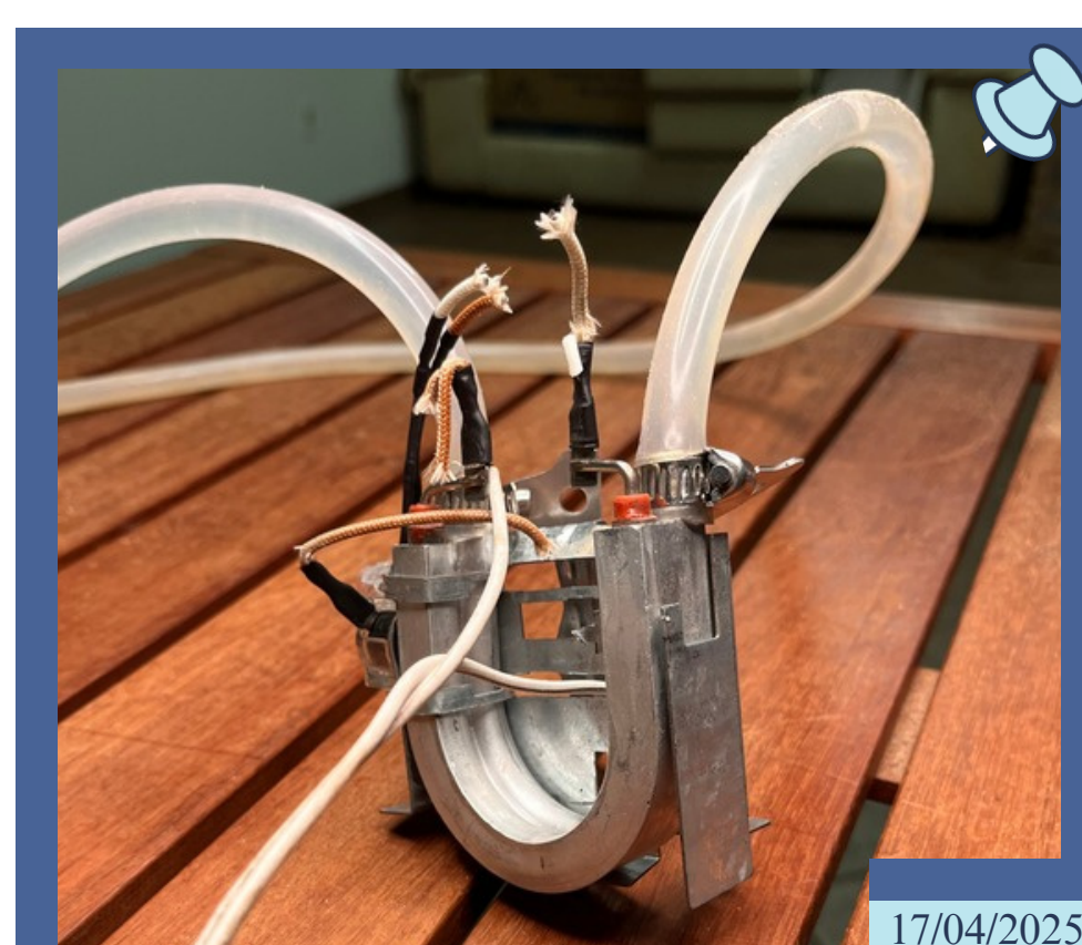
Figura 1: Foto da resistência elétrica usada nas simulações iniciais (Autora, 2025).
