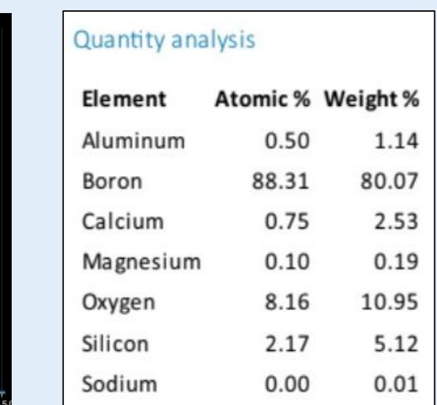
FIGURA 20 - Composição da Fibra de Vidro com Resina a 450°C - Espectrometria de raios X. Fonte: Autoria própria.
