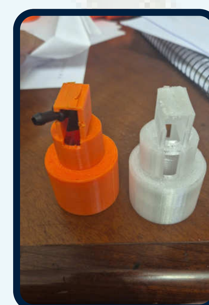
Figura 13. Encaixe do sensor com sistema de autolimpeza
