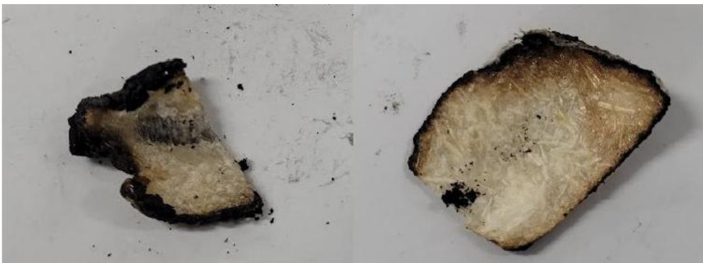
Figura 1. À esquerda, bioplástico convencional, usando amido de milho. À direita, Canaplast (Amostra B4a), bioplástico com bagaço de cana-de-açúcar. Ambos submetidos à chama durante 15 segundos.
