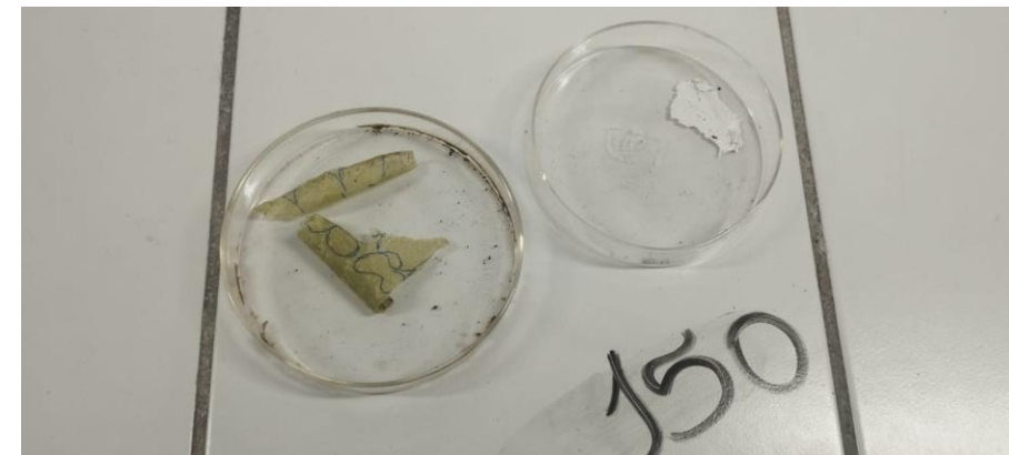
Figura 2. Amostra I09 do Canaplast à esquerda e plástico controle, feito de polipropileno. Ambos foram submetidos à uma temperatura de 150°C durante 30 minutos.
