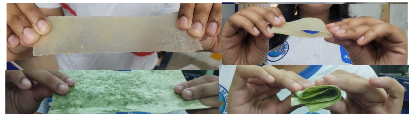
Figura 4. Bioplástico Canaplast apresenta flexibilidade elevada, podendo ser utilizado em embalagens e biofilmes. Acima, amostra B4b, com 0,5mm de espessura. Abaixo, amostra J8a, com 0,1mm de espessura.
