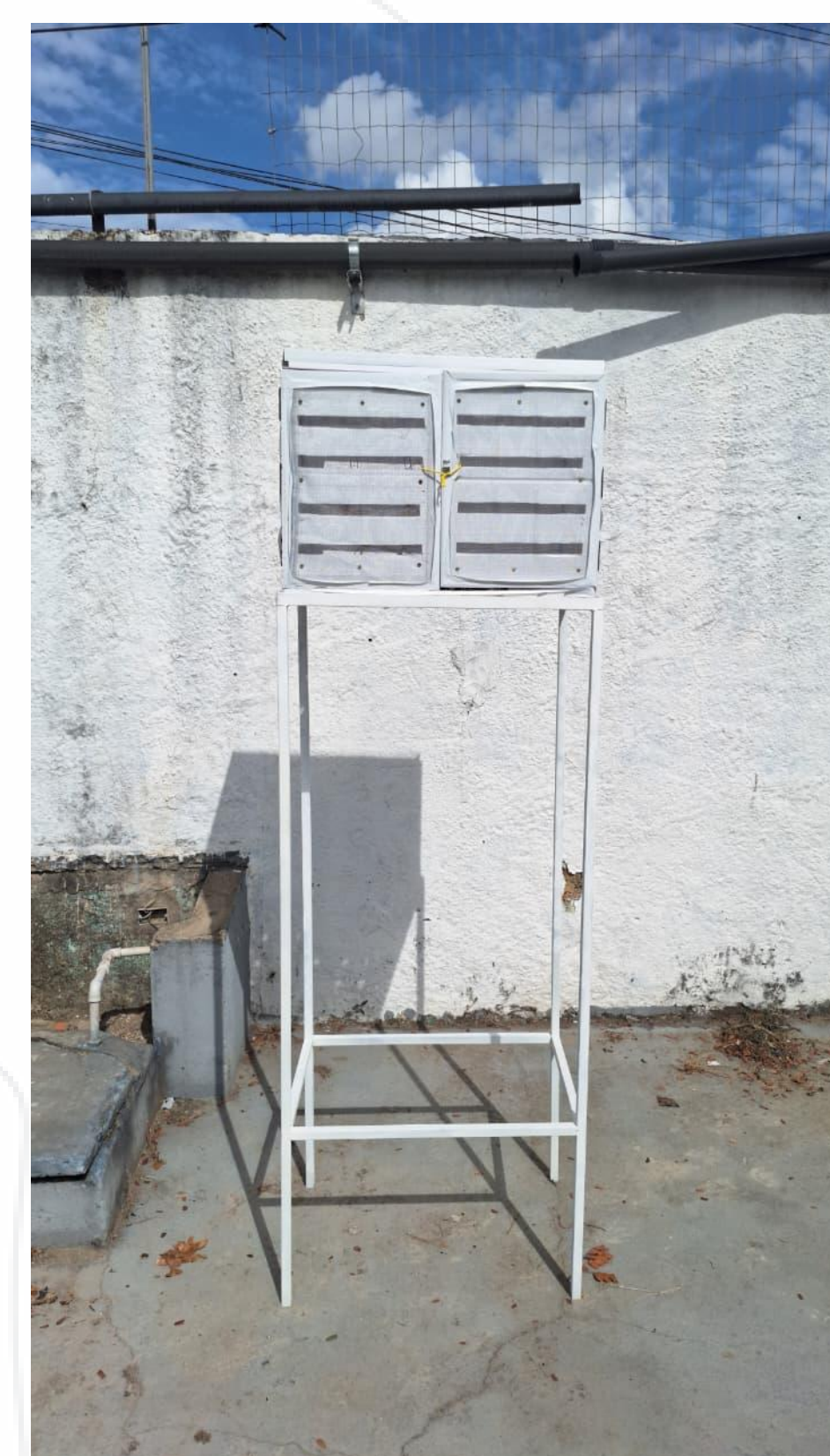
Figura 2: Estação meteorológica feita com placa de forro de PVC.
