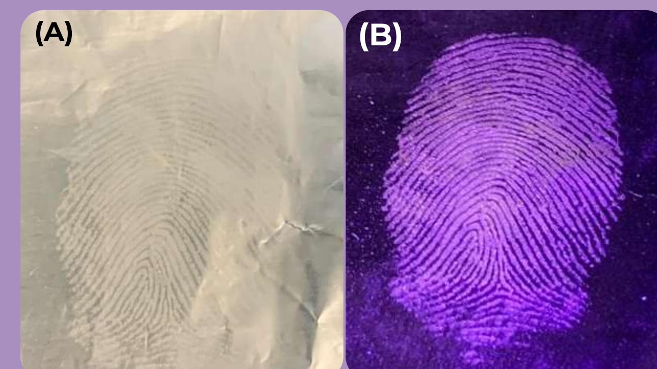
Figura 10 - Impressão digital revelada com o pó do ovo marrom: (A) submetida a luz natural e (B) submetida a luz UV. Fonte: Autoral, 2026.
