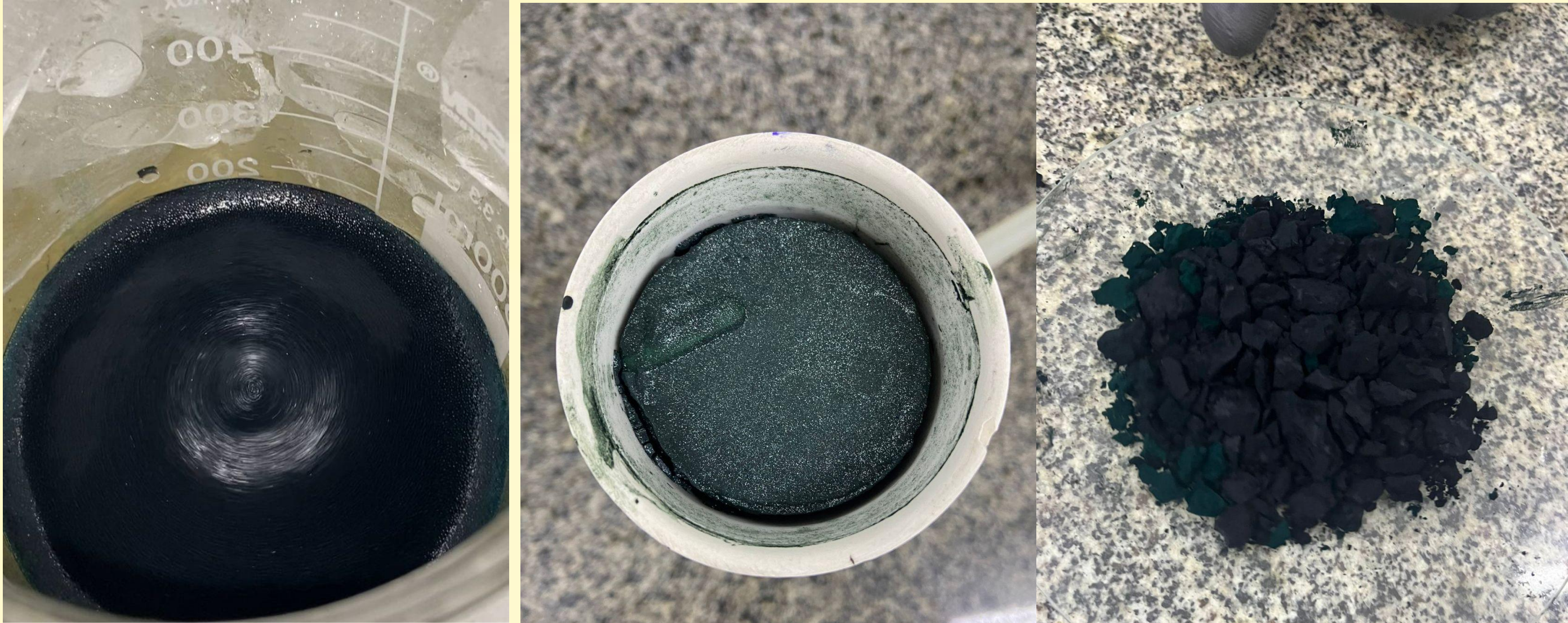
Figura 1 – Síntese química da polianilina; Figura 2 – Filtração a vácuo; Figura 3 – Polianilina pós estufa. Acervo Pessoal, 2025.
