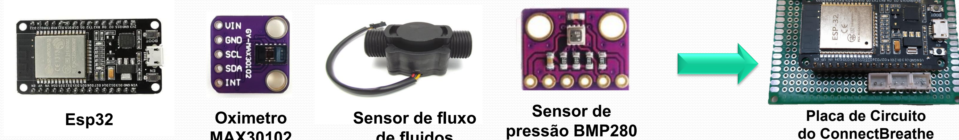
Figura 2 – Componentes Principais do projeto e a Placa de Circuito do projeto.
