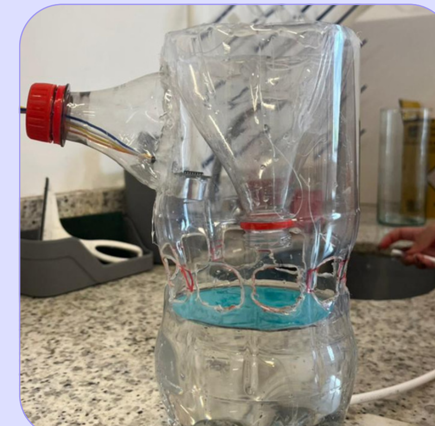
FOTO 5: PROTÓTIPO DO PLUVIÔMETRO DE BAIXO CUSTO
