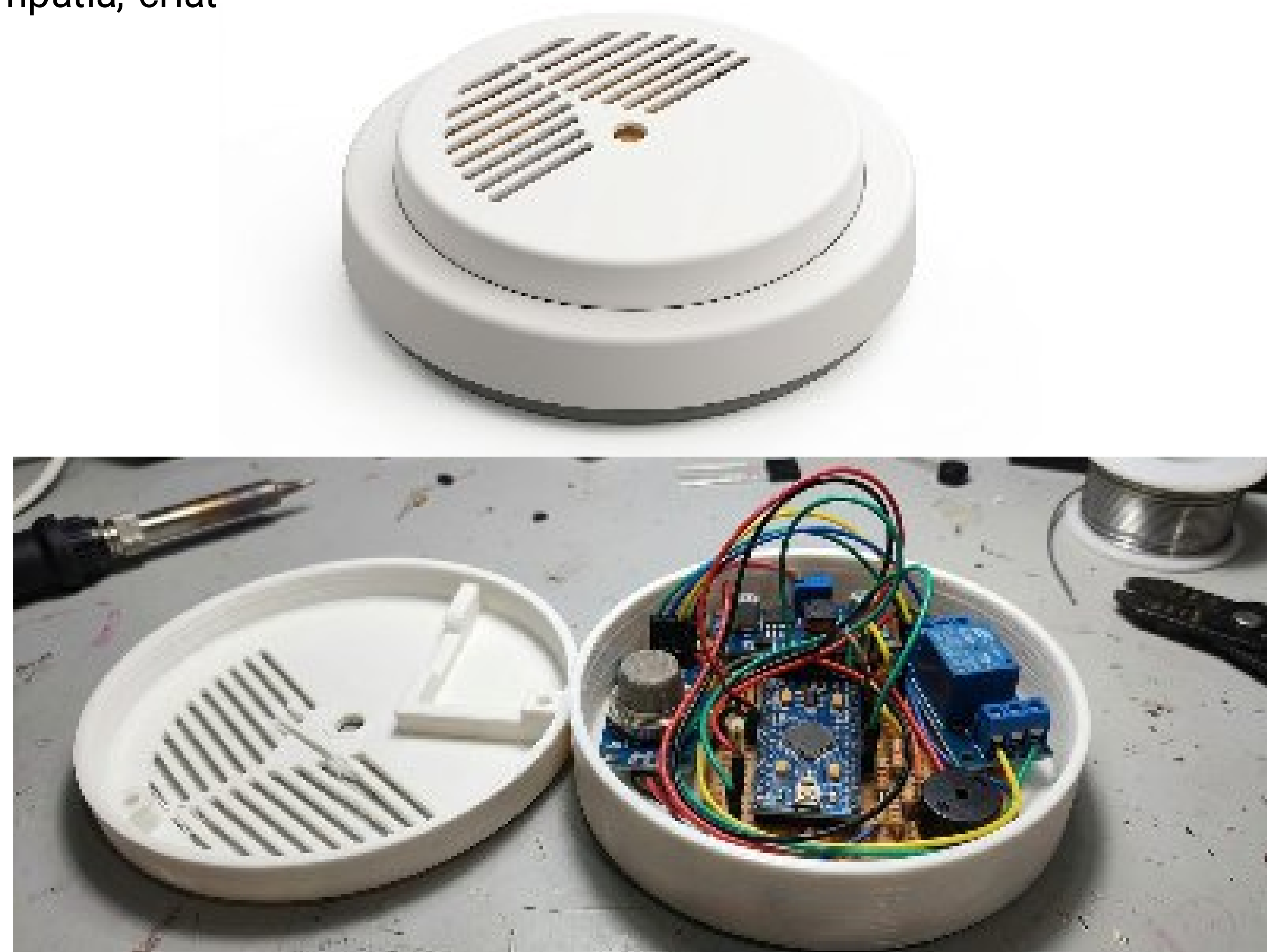
Modelagem 3D e protótipo físico do SS V3, sensor de fumaça desenvolvido para detecção e alerta em ambientes escolares.
